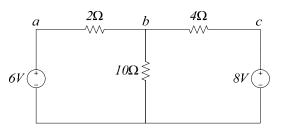
$$-i_{2\Omega} - i_{10\Omega} - i_{4\Omega} = 0$$
